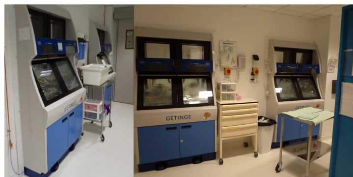
Figure 3 : laveurs désinfecteurs d'endoscopes : porte zone "sale" (gauche) et porte zone "propre" (droite)
